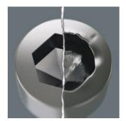
Innensechskantschrauben sind problematisch, die denn Anlageflächen, über die die Kraft vom Werkzeug auf die Schraube übertragen wird, sind sehr schmal. Die Folge: Der Schraubenkopf kann zerstört werden. Hex-Plus Werkzeuge haben größere Anlageflächen, die diese Gefahr verringern. Gut zu wissen: Hex-Plus Werkzeuge passen in jede Sta ndard-Innensechskantschraube!
