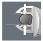
Die parallelen glatten Backen des Doppelmaulschlüssels Joker 6006 ermöglichen eine Flächenpressung und können dadurch das Verrunden der Mutter bzw. des Schraubenkopfes vermeiden, was bei der Kraftübertragung über Ecken auftreten kann.
