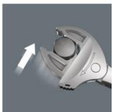
Durch die automatisch stufenlos zugreifenden parallel geführten Backen deckt der Joker Doppelmaulschlüssel 6006 alle Abmessungen im jeweiligen Anwendungsbereich ab. Die benötigte Größe findet der Schlüssel beim Ansetzen an der Mutter oder Schraube Einstellen von selbst.
