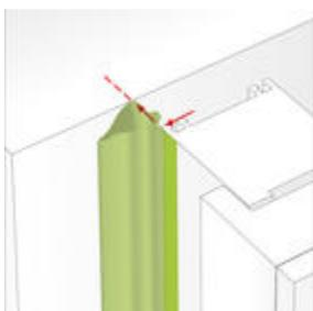
Klebung "einseitig": - Durch Abziehen der Abdeckfolie der Selbstklebung ankleben an der Ansichtsseite des Blendrahmens - Die die Fuge überbrückende, nicht verklebte, Folie muss hinter der roten Linie liegen
