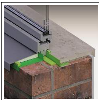
1.Bild: Lösungsmöglichkeit: Innen: ME500 TwinAktiv EW mit SP025 Fensterfolienkleber Öko, Mitte: FM220 Multi-Bauschaum,
