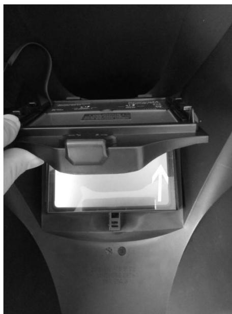
1. Riegel nach links schieben (←) um den Filterhalter zu öffnen.
