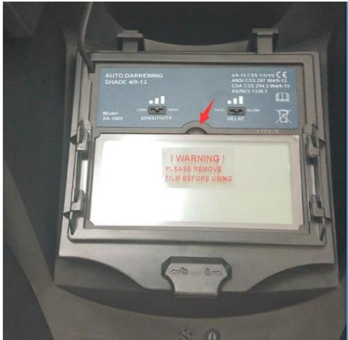
Entfernen Sie die innere Schutzscheibe an der halbrunden Vertiefung (siehe Pfeil) und ersetzen Sie diese durch eine neue Schutzscheibe.
