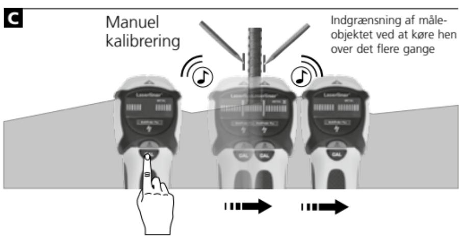
**Tip 1:** Mellem de to markeringer er midten af metalobjektet. På grund af den høje følsomhed kan tykke metalobjekters målte bredde virke bredere end den reelle bredde. Bevæg da efter apparatet hen over det fundne måleobjekt; se figur B. Herved kalibreres apparatet automatisk. Den manuelle kalibrering bør ske i nærheden af det sidst fundne sted; se figur C. Denne fremgangsmåde gentages efter behov.
