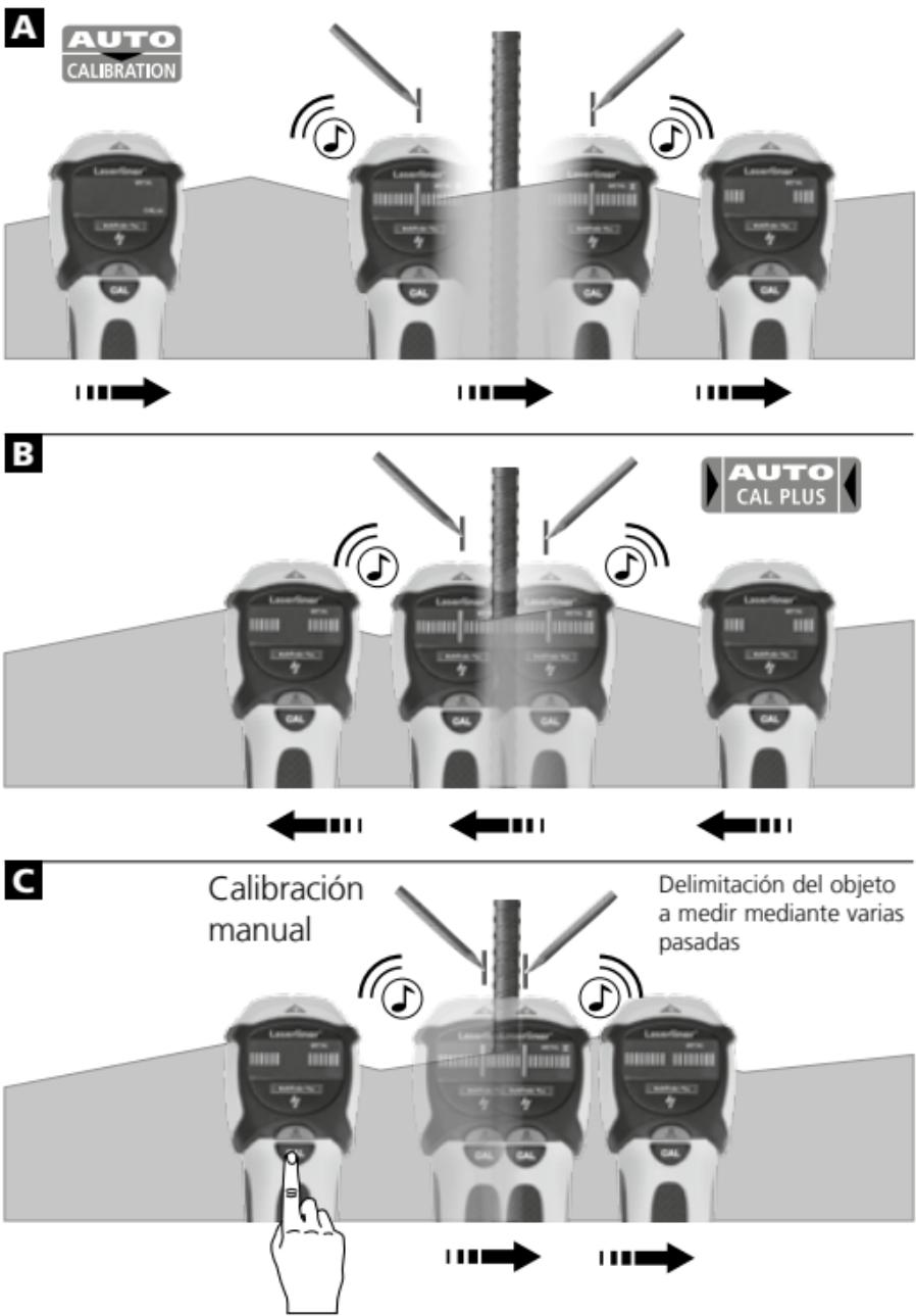
**Consejo 1:** El centro del objeto metálico se encuentra entre las dos marcas. Los objetos metálicos gruesos aparecen más anchos que en la realidad debido a la alta sensibilidad de medición. Es decir, pasar de nuevo el aparato sobre el objeto encontrado, véase al gráfico B. El aparato se calibra para ello automáticamente. La calibración manual deberá realizarse cerca el último punto encontrado, véase gráfico C. Repita el procedimiento si es preciso.
