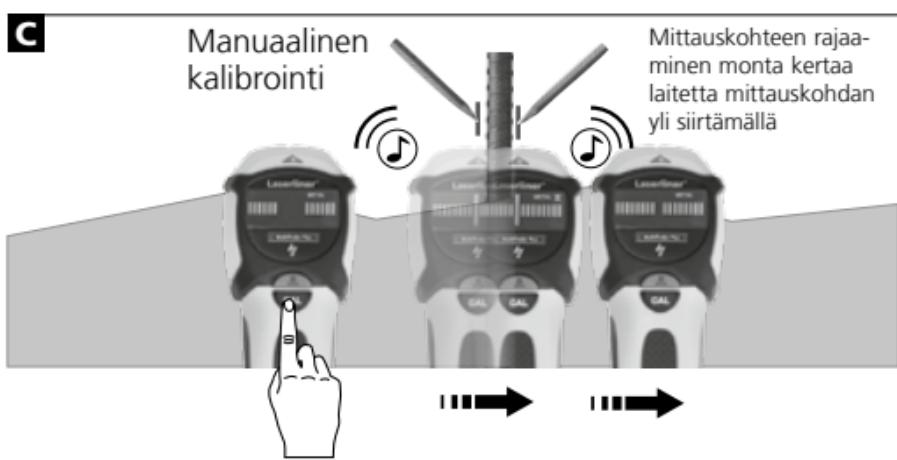
Vihje 1: Metalliesineen keskikohta on näiden kahden merkinnän välissä. Mittausherkkyyden vaikutuksesta paksut metalliesineet näkyvät todellisuutta leveämpinä. Rajaa mittauskohde siirtämällä laitetta monta kertaa mittauskohdan yli, ks. kuva B. Samalla laite kalibroi itsensä automaattisesti. Manuaalinen kalibrointi tulisi tehdä viimeisimpänä havaitun koteen lähellä, ks. kuva C. Toista menettely tarvittaessa.
