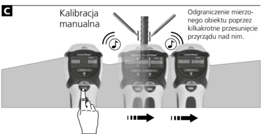
Wskazówka 1: pomiędzy oboma zaznaczonymi punktami znajduje się środek metalowego obiektu. Ze względu na wysoką czułość pomiarową grube obiekty metalowe wydają się być szersze niż w rzeczywistości. Należy ponownie przesuwać przyrząd nad wykrytym mierzonym obiektem, patrz rys. B. Przyrząd kalibruje się przy tym automatycznie. Manualna kalibracja powinna nastąpić w pobliżu ostatniego znalezionej miejsca, patrz rys. C. W razie potrzeby powtórzyć te czynności.
