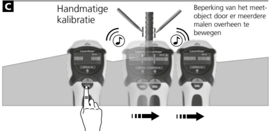
Tip 1: Tussen beide markeringen in ligt het midden van het metalen object. Door de hoge meetgevoeligheid verschijnen dikke metaalobjecten breder dan deze in werkelijkheid zijn. Beweeg het apparaat daarom opnieuw over het gevonden meetobject, zie grafiek B. Het apparaat kalibreert hierbij automatisch. De handmatige kalibratie dient in de buurt van de als laatste gevonden positie te worden uitgevoerd, zie grafiek C. Herhaal deze werkstappen zo nodig.
