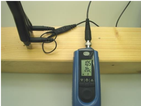
Abbildung 4-1 Messung quer zur Faserrichtung mit M 20
