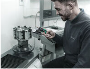
Drehmomentschraubendreher mit Schnelleinstellung
