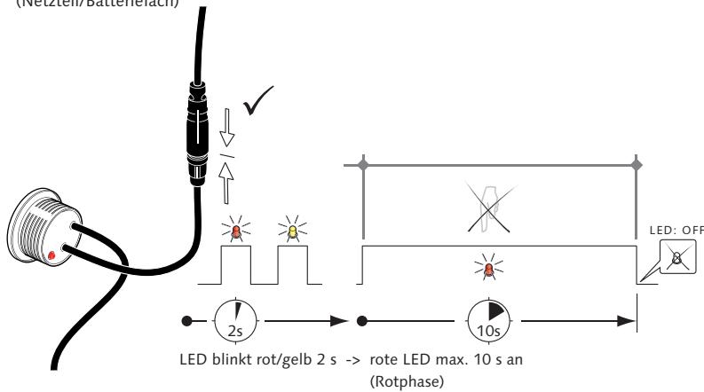
**1. Spannungsversorgung herstellen (Netzteil/Batteriefach)**
