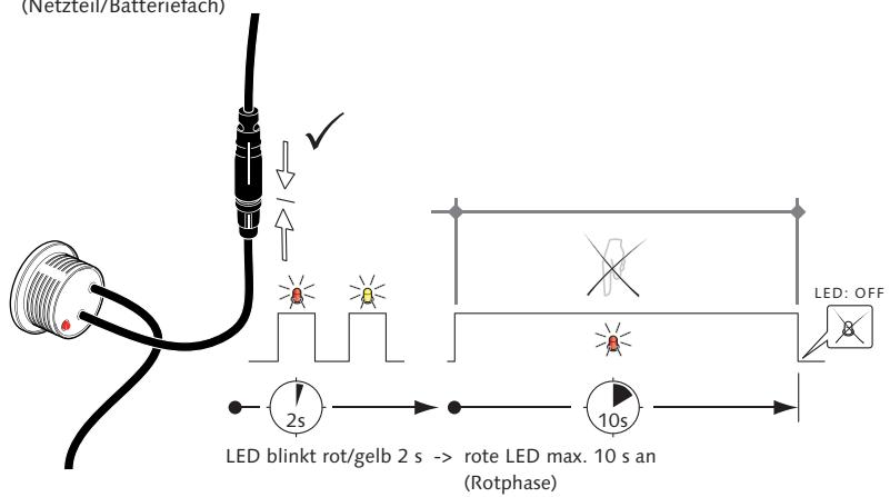
**1. Spannungsversorgung herstellen (Netzteil/Batteriefach)**
