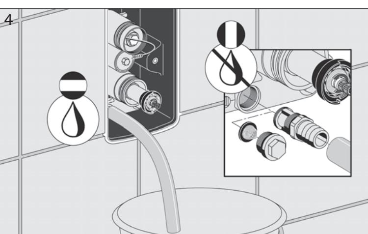
**PL** • Przepłukać przewody zgodnie z DIN 1988 przy użyciu króćca do przepłukiwania (w zestawie). Po płużaniu ponownie otworzyć wstępny zawór odcinający.
