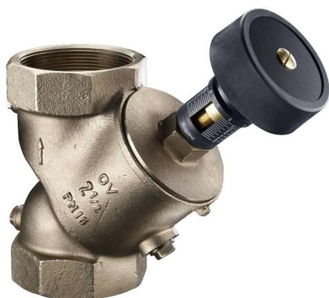
Strangregulierventil für den statischen hydraulischen Abgleich von Rohrnetzen in geschlossenen Heizungs- und Kühlwasseranlagen. Es bietet eine Messfunktion über den Ventilsitz, die im Auslieferungszustand jedoch mit Blindstopfen verschlossen ist.
