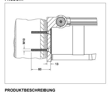
Nr. 8 bestehend aus: 2 x Senkschraube mit Innensechskant DIN 7991 M10x60 V2A, direkte Befestigung ohne Dübel
